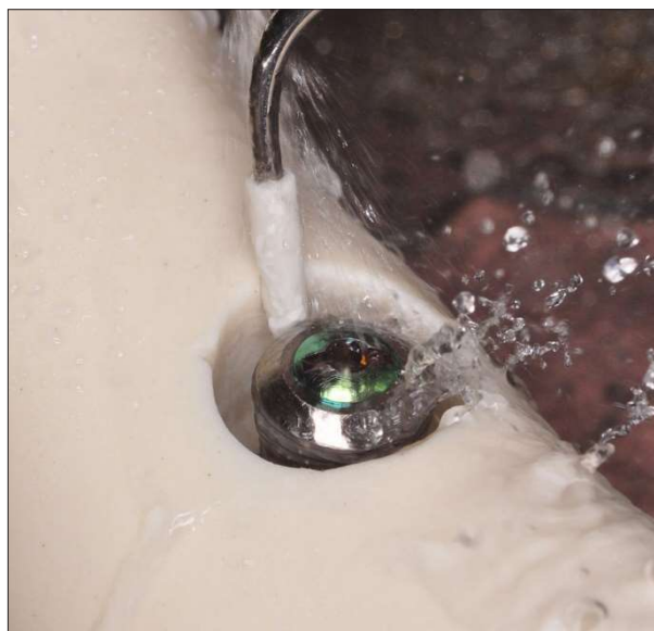
Figure 1. ウッドペッカー社製ソニックスケーラーPT5(中国)を用い、水圧0.5MPa、先端振動数28kHz、出力20Wのパラメーターで2分間連続作業を行い、機械的バイオフィルム除去のみを行った。
